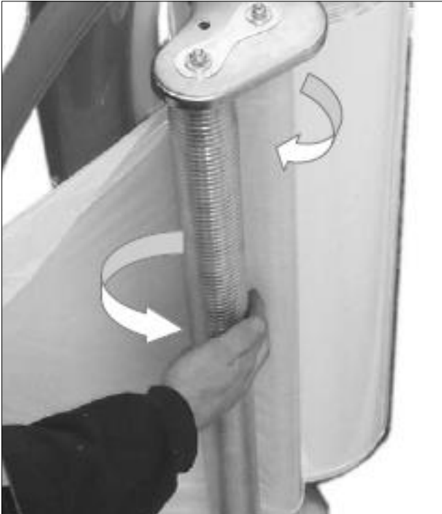
Folyonun serbest ucu balya üzerine yerleşmişken, folyo yukarıdaki resme göre germe silindirlerinin arasında döner.
