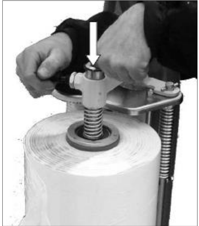
Topuzu gevşetin ve dingil pimine sert bir şekilde bastırın, böylece düğme tekrar çıt sesi çıkarır
