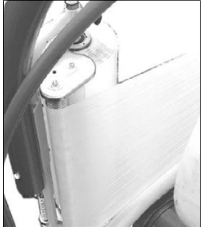
Folyonun serbest ucu balya üzerine yerleşmişken, folyo yukarıdaki resme göre germe silindirlerinin arasında döner.
