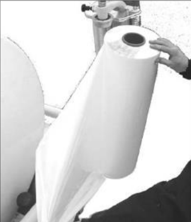
Ruloyu yerleştirin, böylece dış taraftan açılır
